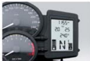
El **RDC** (Sistema de Control de la Presión de los Neumáticos) proporciona más seguridad, ya que informa al conductor de la presión actual de los neumáticos. Las variaciones relevantes se muestran inmediatamente en el display o por medio de un piloto de aviso.
