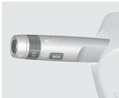
Para activar la computadora de a bordo, gire el mando de la palanca de los intermitentes.
