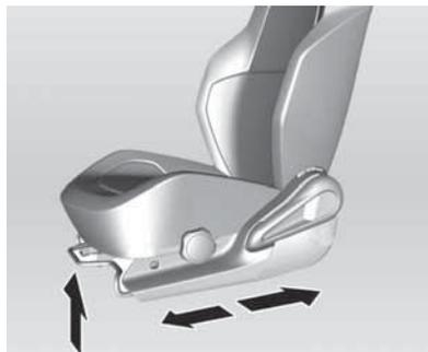
Tire del palanca, deslice el asiento, suelte el palanca.
