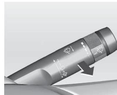
Tire de la palanca. El líquido de lavado se rocía en el parabrisa y los limpiaparabrisas realizan unos cuantos barridos.
