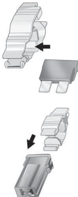
Coloque el extractor de fusibles sobre los diversos tipos de fusible, desde la parte superior o lateral, y extraiga el fusible.
