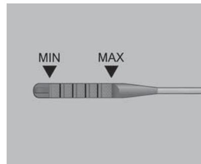
Límpiala bien e insértela completamente, vuelva a extraerla y compruebe el nivel de aceite, que debe estar entre las posiciones superior (MIN) e inferior (MAX) de la varilla de medición.
