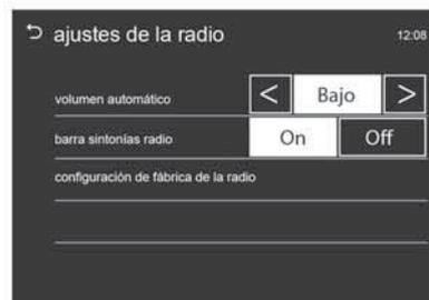
3. Pulse [  $<$  /  $>$  ] para configurarlo en desactivado/bajo/medio/alto.
