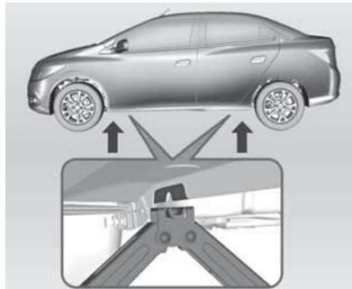
3. Ajuste el gato a la altura necesaria. Coloque el gato directamente debajo del punto de elevación, de modo que no pueda resbalar.
