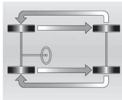
Las fuerzas que actúan sobre los neumáticos delanteros y traseros son diferentes, por eso se desgastan de forma diferente dependiendo de varios factores, como la superficie de la calzada, la forma de conducir, la alineación de la suspensión, el equilibrado de las ruedas, la presión de los neumáticos, etc.
