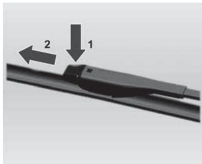
Levante el brazo del limpiaparabrisas. Presione la lengüeta de bloqueo (flecha 1) y tire de la escobilla para extraerla (flecha 2).
