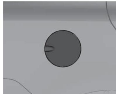
El tapón del depósito debe abrirse con la llave. Desbloquee la tapa del depósito de combustible tirando de la tapa.
