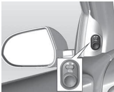
Seleccione el retrovisor izquierdo o derecho con el selector y ajústelo con el llave de cuatro posiciones.
