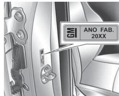
La placa del año de fabricación del vehículo está situada en el pilar de la puerta delantera derecha.
