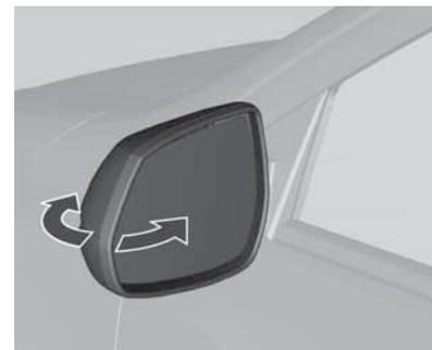
Para la seguridad de los peatones, los retrovisores exteriores basculan de su posición de montaje normal al recibir impactos de una determinada fuerza. Vuelva a colocar el retrovisor en su posición presionando ligeramente sobre la carcasa. Esta función también es útil para reducir el ancho total del vehículo y evitar daños cuando el vehículo está estacionado.
