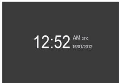
**Nota:** La temperatura se muestra cuando el interruptor de encendido (llave de encendido del vehículo) se encuentra en la posición **2**.
