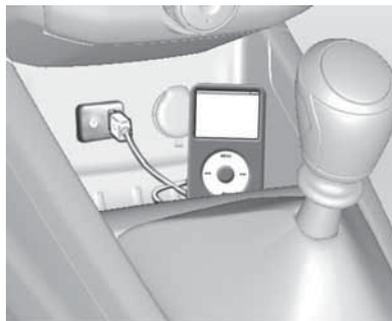
Debajo del tablero de instrumentos hay una conexión para el iPod/iPhone con los archivos de música que desea reproducir en el terminal de conexión USB.
