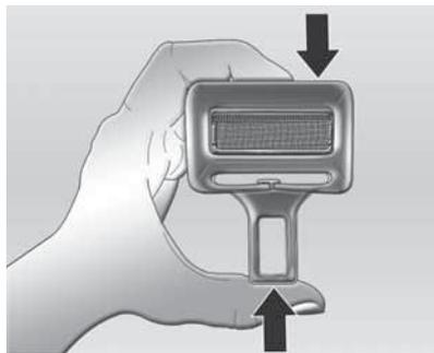
El cinturón de seguridad para el asiento central trasero es un cinturón abdominal. Para ajustar su longitud, pulse en la parte superior e inferior de la tapa de la lengüeta y apriete o afloje el cinturón.
