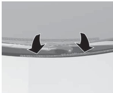
La entrada de aire en el compartimento del motor, delante del parabrisas, debe estar libre para permitir la entrada de aire. Retire las hojas y limpie la suciedad.
