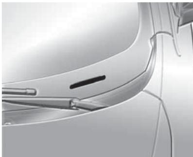
La placa con el número de identificación del vehículo se encuentra en la esquina delantera del tablero de instrumentos, en el lado del conductor. Es visible desde fuera a través del parabrisas.
