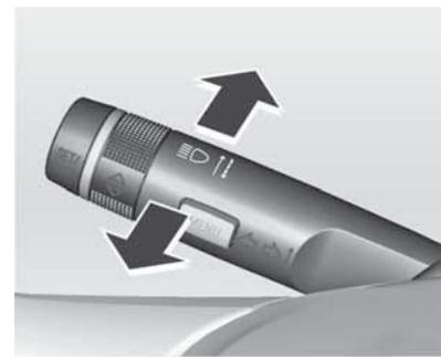
Para un destello de luz alta, tire de la palanca de las luces de giro.
