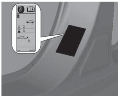
La etiqueta de la presión de los neumáticos está situada en el montante de la puerta delantera izquierda.
