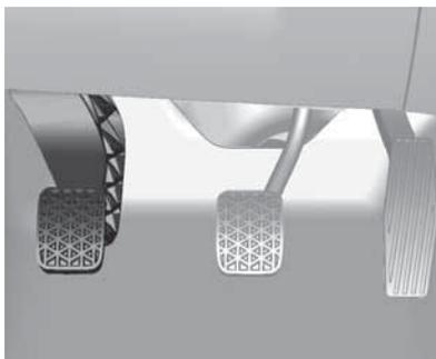
**Nota:** No conduzca con el pie en el pedal del embrague. Este hábito puede provocar daños en el sistema de embrague y motor, además de aumentar el consumo de combustible.
