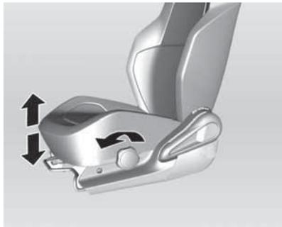
El ajuste de la altura del asiento solo es posible en el asiento del conductor.
