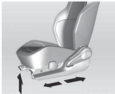
Tire del palanca, deslice el asiento, suelte la palanca.
