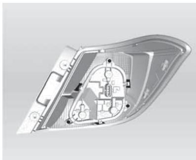
4. Desenrosque los fiadores y libere las pestañas de bloqueo, como se muestra en la ilustración.
