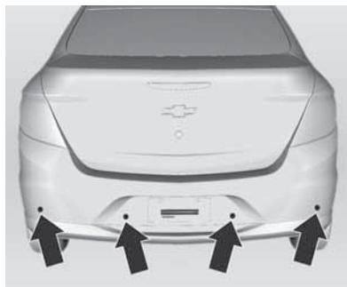
El sensor de estacionamiento facilita el estacionamiento midiendo la distancia entre el vehículo y los posibles obstáculos traseros y emitiendo señales acústicas.
