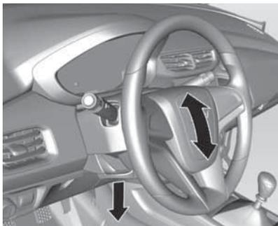
Desbloquee la palanca, ajuste la altura del volante y vuelva a bloquearla. Asegúrese de que esté completamente bloqueada.
