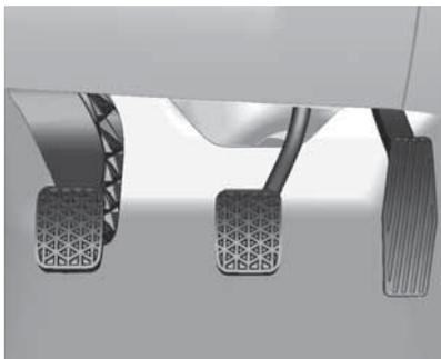
Se recomienda usar solo las cubrealfombras originales diseñadas por Chevrolet para este vehículo para asegurarse de que el recorrido del pedal no se vea limitado. No debería colocar otras cubrealfombras.
