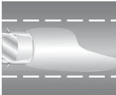
La luz baja está diseñada para iluminar determinadas áreas con mayor intensidad, proporcionando la visualización de señales y disminuyendo el efecto deslumbrante a los conductores que se aproximan por el carril contrario.
