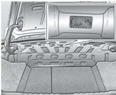
Se enciende y apaga automáticamente al abrir las puertas y/o el baúl, al sacar la llave del encendido y al recibir una orden del mando a distancia para desbloquear las puertas.
