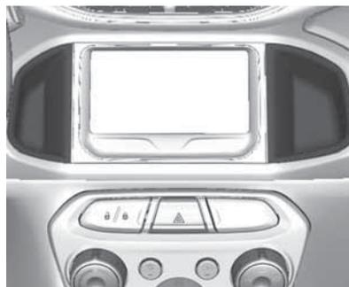
En los vehículos con sistema de infoentretenimiento, hay dos compartimentos portaobjetos en el tablero de instrumentos. Se pueden usar para guardar objetos pequeños.
