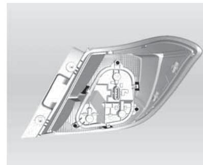
7. Instale las bombillas en el conjunto de luces traseras, presione contra las lengüetas de bloqueo e instale los fiadores de forma correcta.
