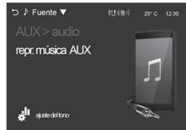
**Nota:** Si el dispositivo auxiliar ya estuviera conectado, pulse [INICIO (⏮)] > [audio] > [Source ▼] (Fuente) > [AUX] para reproducir la música del dispositivo auxiliar.
