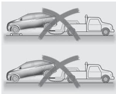
El remolque mediante 2 ruedas no es adecuado y podría causar daños al vehículo.
