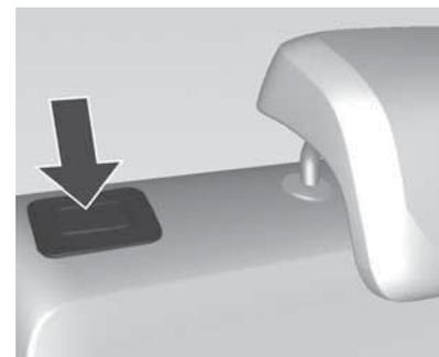
Si el respaldo de los asientos traseros está dividido en dos partes, pulse el botón de liberación de uno o ambos lados y abata los respaldos contra la banqueta del asiento. Si el respaldo no está dividido en dos partes, pulse el botón de liberación situado en ambos lados para abatirlo.
