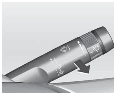
Tire de la palanca. Se rocía líquido de lavado sobre el parabrisas y los limpiaparabrisas se accionan durante varios ciclos.
