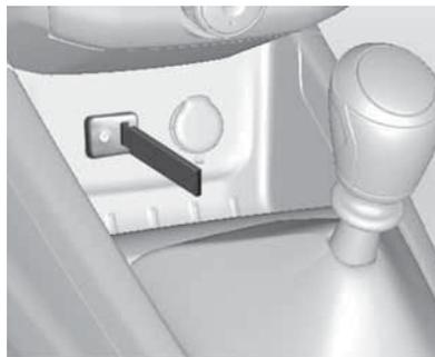
Debajo del tablero de instrumentos hay un puerto para conectar el dispositivo de almacenamiento USB con los archivos de música que desea reproducir al terminal de conexión USB.
