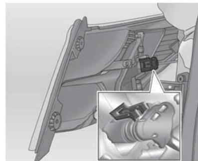
3. Retire la pestaña de bloqueo del conector y retire el conector del conjunto de las luces traseras.
