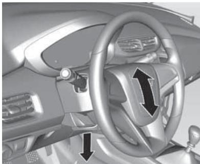
Desbloquee la palanca, ajuste la altura del volante, luego enclave la palanca y asegúrese de que esté totalmente bloqueada.
