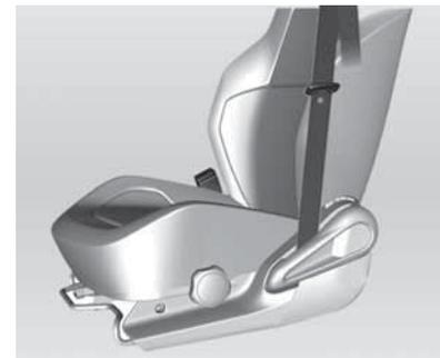
En caso de una colisión frontal o trasera de una determinada gravedad, se tensa el cinturón de seguridad del conductor.
